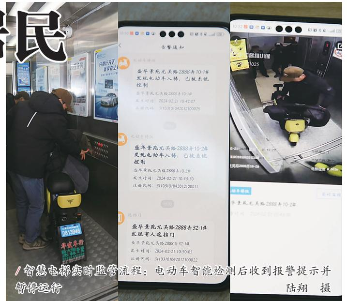
智慧电梯实时监控流程:电动车智能检测后收到报警提示并暂停运行
