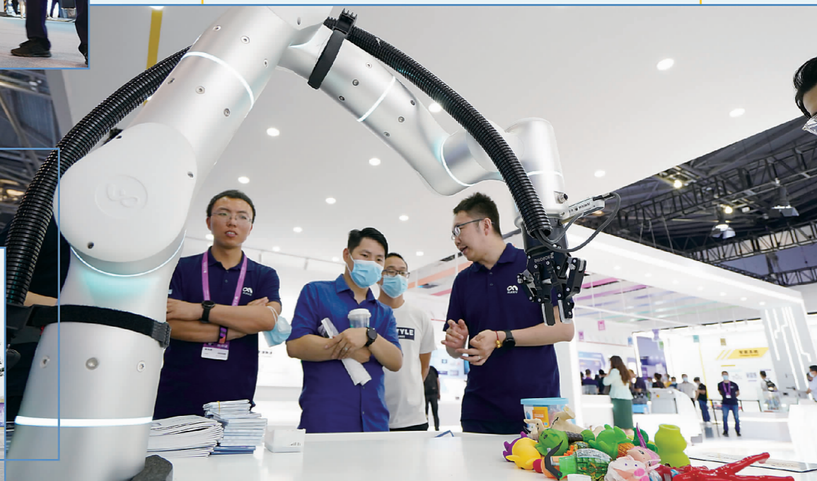
▼ 非夕科技机器人对复杂场景内的物体进行通用高速抓取不受物体形状材质限制，且机器人的手指拥有近似人类手指的感知和抓取能力。
