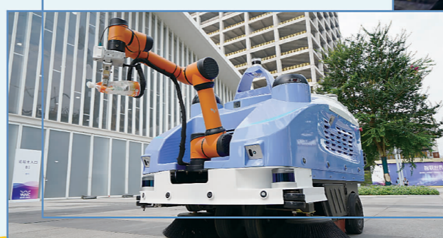
▼ 人工智能垃圾分拣机器人可对回收物进行分选。
