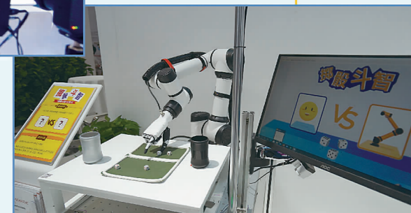
▼ 非夕科技机器人对复杂场景内的物体进行通用高速抓取不受物体形状材质限制，且机器人的手指拥有近似人类手指的感知和抓取能力。
